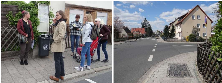
● Abbildung 12: Schmalen Gehweg in der Äußeren Tennenloher Straße mit fehlendem Wartebereich Haltestelle Röntgenstraße (links) und fehlende Querungshilfe Einmündung Bunsenstraße (rechts)
