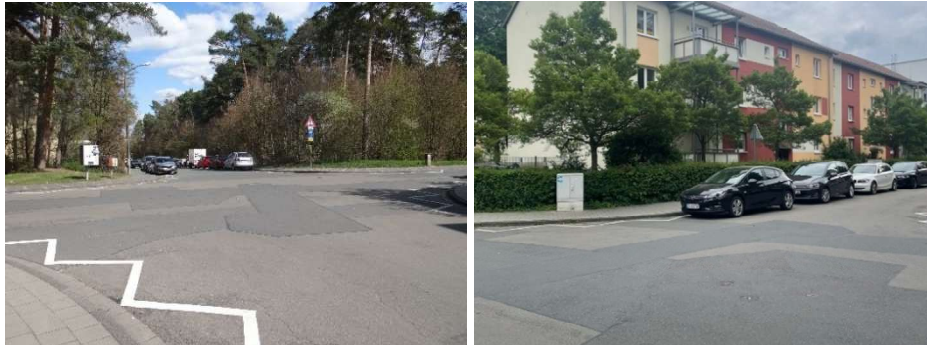
● Abbildung 3: Fehlende Bordsteinabsenkung und zugeparkte Einmündungen an der Kreuzung ZeiBstraße/Eggenreuther Weg
